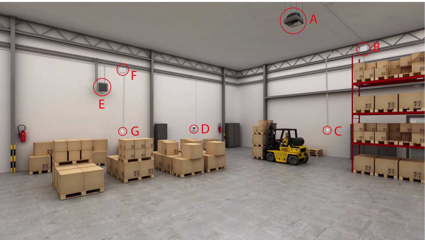
Figura 8.1 Esempio posizionamento componenti sistema Air Tech
